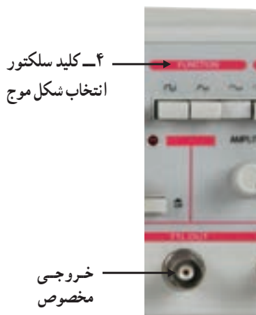
شکل ۱۰۱-۲ کلید سلکتور انتخاب شکل موج
