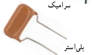
شکل ۲۰-۲- انواع خازن‌ها با توجه به نوع عایق آن
