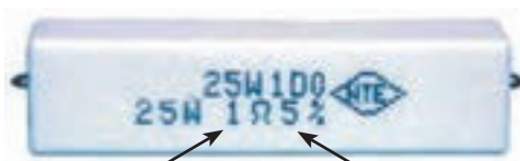
تولرانس 5\% درصد مقدار مقاومت یک اهم
