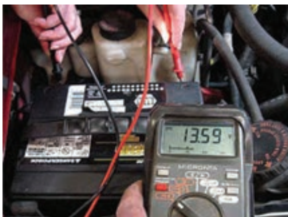
شکل ۵۰-۱ اندازه‌گیری ولتاژ با ولت‌متر دیجیتال
