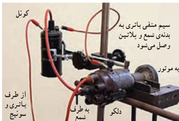
شکل ۱۴۴-۲- مدار شبیه‌سازی شده‌ی سیستم جرقه‌زنی
