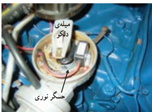
شکل ۱۴۵-۲- سه نمونه حسگر استفاده‌شده در سیستم جرقه‌زنی
