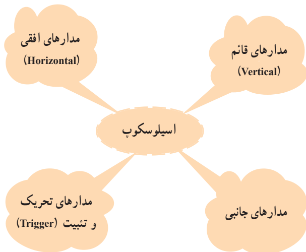
شکل ۱۲۰-۲- مدارهای موجود در اسیلوسکوپ
