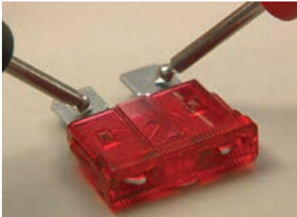
شکل ۸۱-۲ اتصال فیوز به اهم متر
