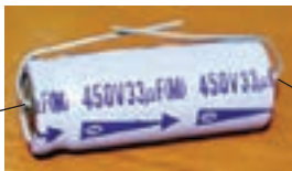
الف - توجه به قطب‌های خازن الکترولیتی
