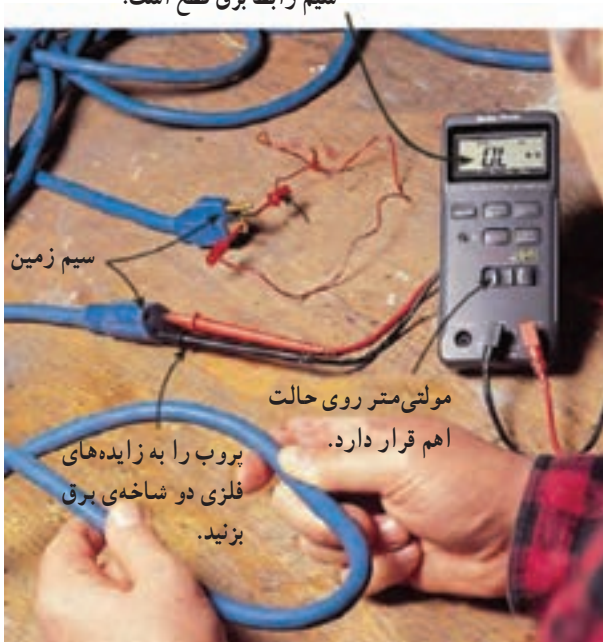
شکل ۲-۸۰ - آزمایش سیم رابط برق دستگاه.
