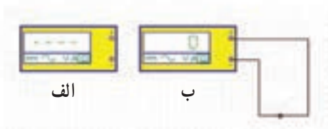
شکل ۲-۷۹ - آزمایش اطمینان از سلامت اهم متر
