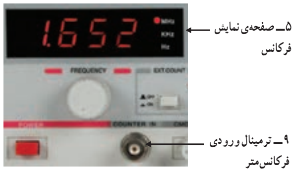
شکل ۱۰۳-۲ فرکانس متر و ترمینال ورودی آن
