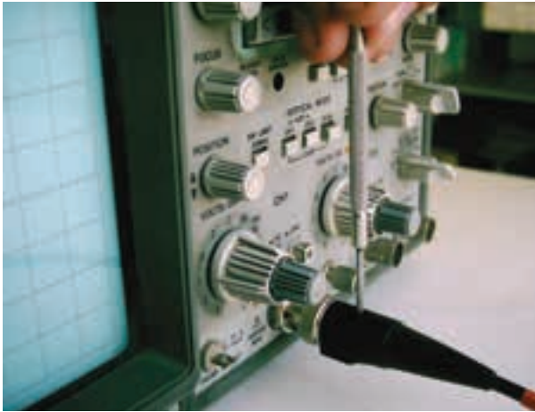
شکل ۱۱۵-۲- نحوه‌ی تنظیم پروب برای به دست آوردن موج مربعی کامل و دقیق
