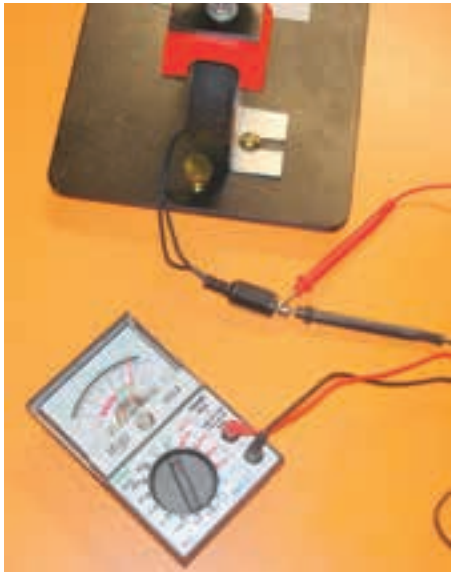
شکل ۸۴-۲-ج - آزمایش به وسیله‌ی اهم متر عقربه‌ای
