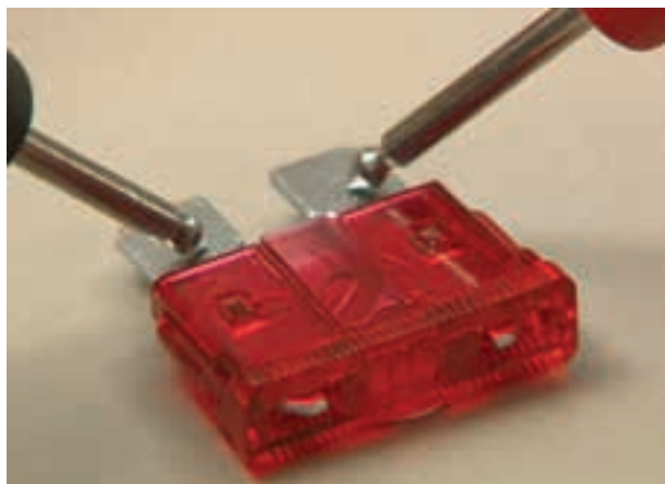
شکل ۸۱-۲ اتصال فیوز به اهم متر
