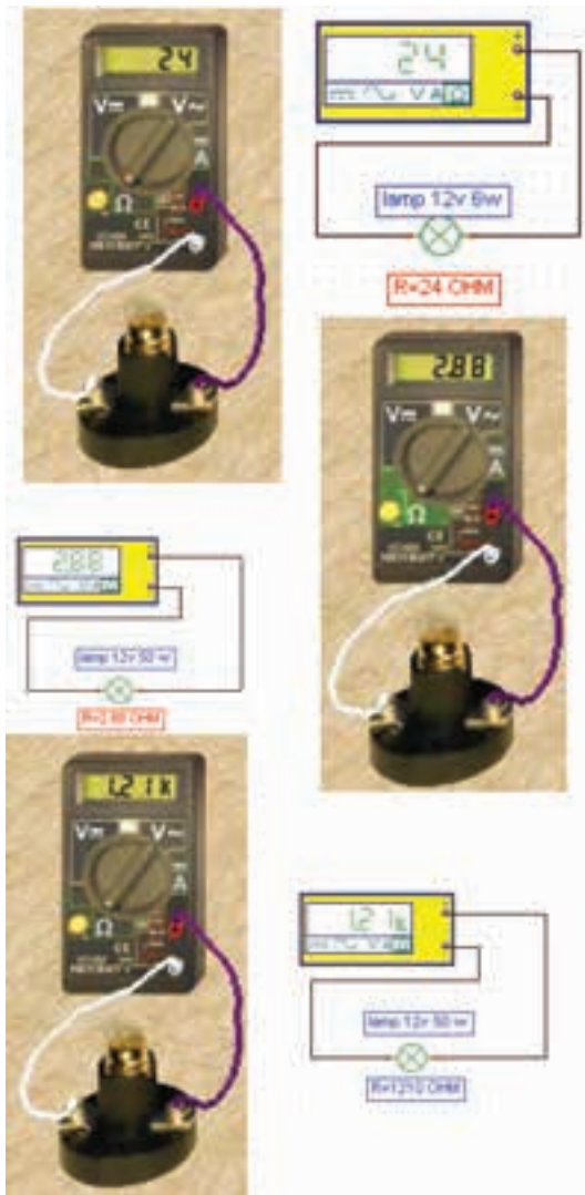
شکل ۸۹-۲- اندازه گیری مقاومت لامپ‌های روشنایی
