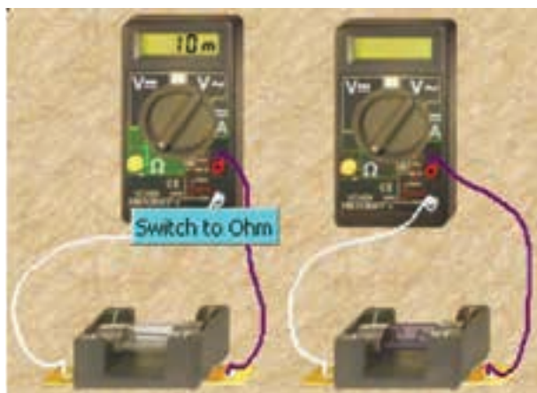
الف - فیوز سالم است اهم متر صفر نشان می‌دهد. ب - فیوز سوخته است اهم متر مقاومت زیادی را نشان می‌دهد.
