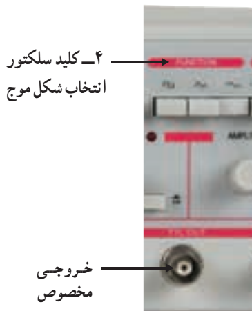
شکل ۱۰۱-۲ کلید سلکتور انتخاب شکل موج
