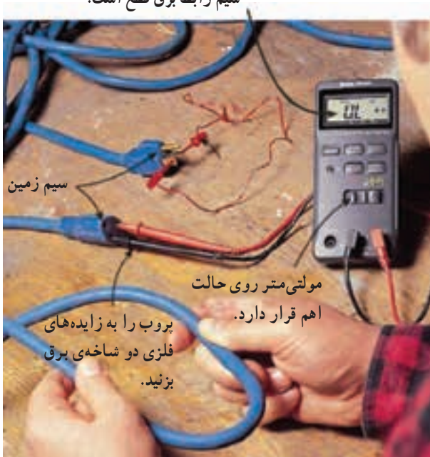
شکل ۲-۸۰ - آزمایش سیم رابط برق دستگاه.
