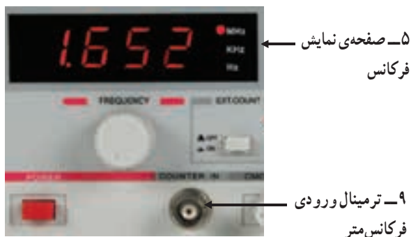
شکل ۱۰۳-۲ فرکانس متر و ترمینال ورودی آن
