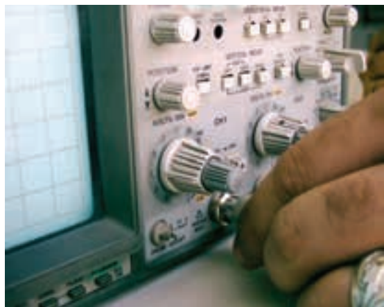
شکل ۱۱۴-۲ نحوه‌ی اتصال BNC به اسیلوسکوپ
