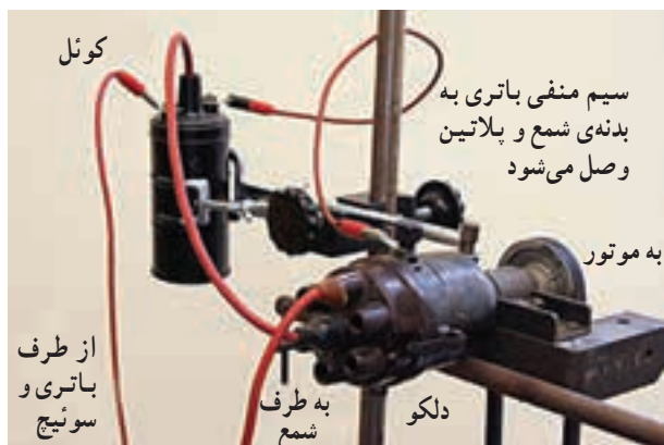
شکل ۱۴۴-۲- مدار شبیه‌سازی شده‌ی سیستم جرقه‌زنی
