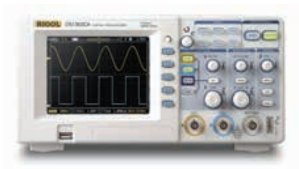
شکل ۱۳۲-۲. اسیلوسکوپ دو کاناله‌ی دیجیتالی. اسیلوسکوپ دو کاناله می‌تواند و شکل موج را به‌طور هم‌زمان روی نمایش‌گر نشان دهد.
