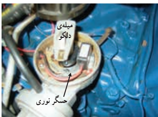
شکل ۱۴۵-۲- سه نمونه حسگر استفاده‌شده در سیستم جرقه‌زنی
