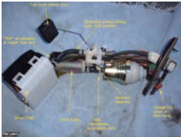
شکل ۱۸۲-۲- یک نمونه حسگر سطح سوخت قدیمی
