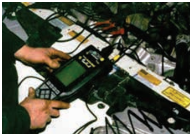
شکل ۲-۱۹۴- یک نمونه دستگاه اسکنر کوچک دستی
