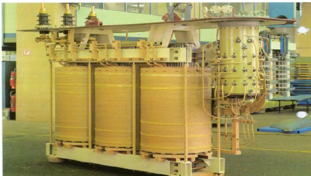
شکل سیم پیچ های ترانسفورماتور
