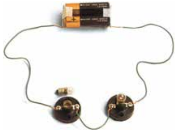
شکل ۳-۱۰ قطع سیم یا لامپ موجب قطع شدن مدار سری می‌شود.
