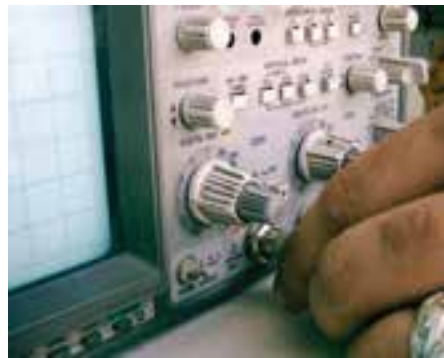
شکل ۶-۶ نحوه‌ی اتصال BNC به اسیلوسکوپ
