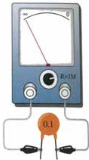
شکل ۵۱-۷ خازن قطع است
