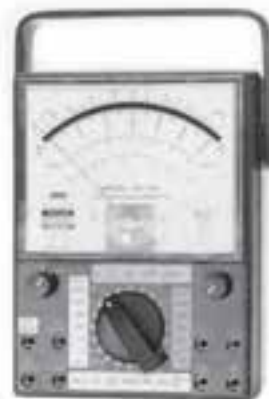
شکل ۲۳-۲ یک نمونه مولتی متر عقربه ای (آنالوک)
