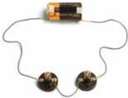
شکل ۲-۲۹ مدار واقعی دو لامپ به صورت سری
