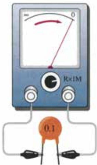
شکل ۵۲-۷ خازن اتصال کوتاه
