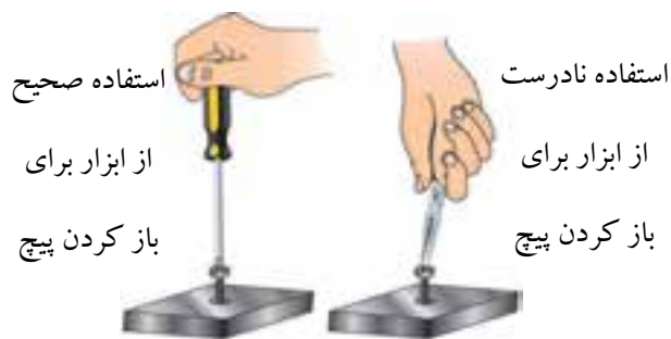
شکل ۳۵-۱ انتخاب درست ابزار کار و نحوه ی کاربرد صحیح آن
