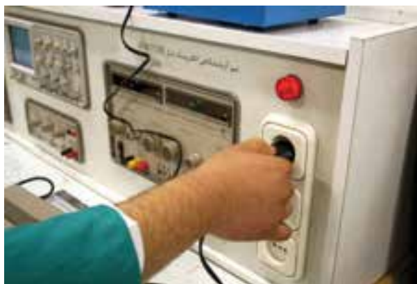
شکل ۱-۳۸ اتصال صحیح دو شاخه
