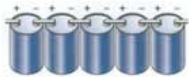
شکل ۲-۱۲۰ اتصال سری پیل‌ها
