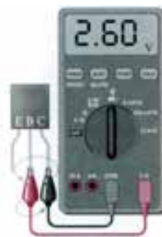
شکل ۱۲-۴۹ ترانزیستور معیوب (قطع)
