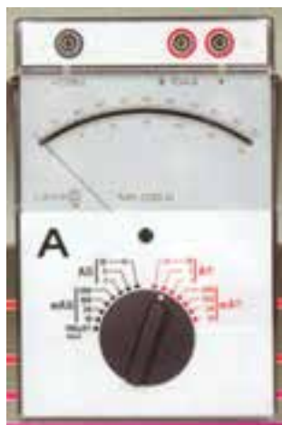
شکل ۱-۴۹ یک نمونه آمپر متر آزمایشگاهی
