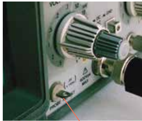
خروجی موج مربعی با فرکانس ۱ KHz و ۰/۵ ولت
