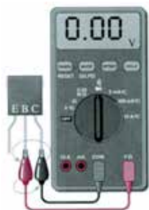
شکل ۱۲-۵۰ ترانزیستور معیوب (اتصال کوتاه)
