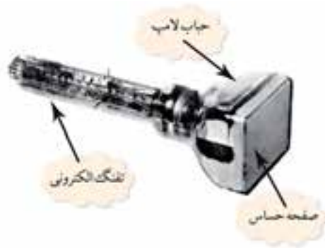
شکل ۲-۶ شکل ظاهری یک لامپ اشعه کاتدی
