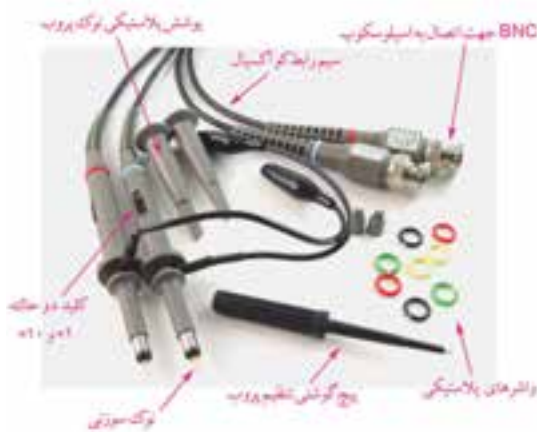
شکل ۵-۶ پروب و اجزای آن
