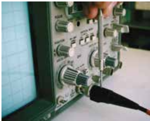
شکل ۸-۶ نحوه‌ی تنظیم پروب
