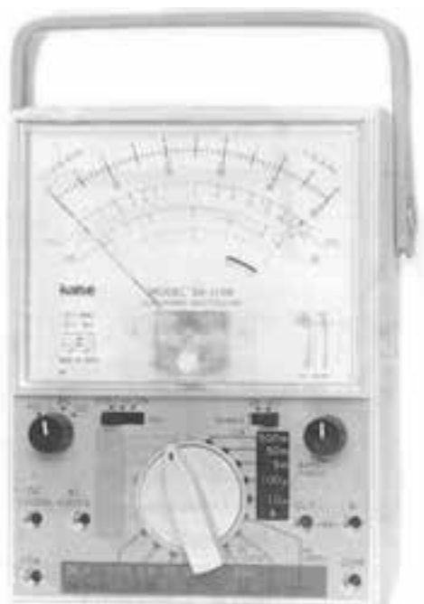
شکل ۲۲-۲ یک نمونه مولتی‌تر عقربه‌ای (آنالوگ)
