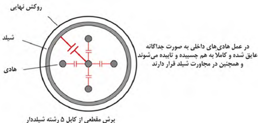
شکل ۳. نمای ظرفیت خازنی پارازیتی در یک کابل چند رشته.
