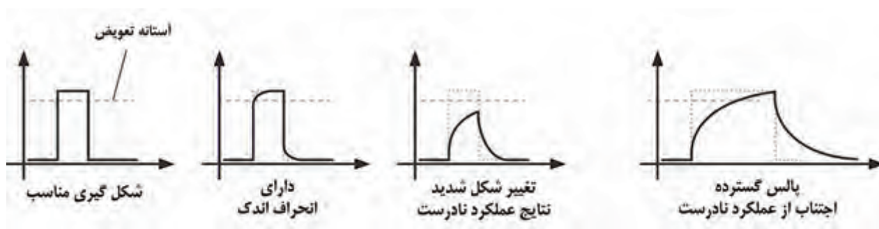
شکل ۲. پالس‌های آزمون منحرف شده توسط امپدانس خروجی و ظرفیت خازنی طبیعی کابل (پالس ۲ و ۳) می‌توانند منجر به عملکرد نادرست شوند (پالس ۳) مگر اینکه پالس آزمون تنظیم شود (پالس ۴).
