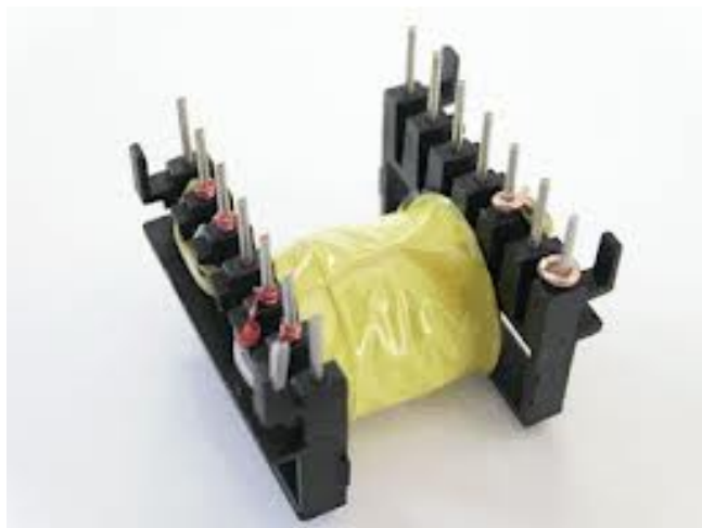
شکل ( ۴-۱۷ ) نمایی از یک قرقره ترانس سوئیچینگ
