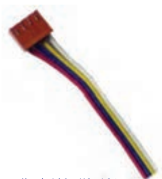
شکل ۲۶ - کابل اتصال صفحه نمایش
