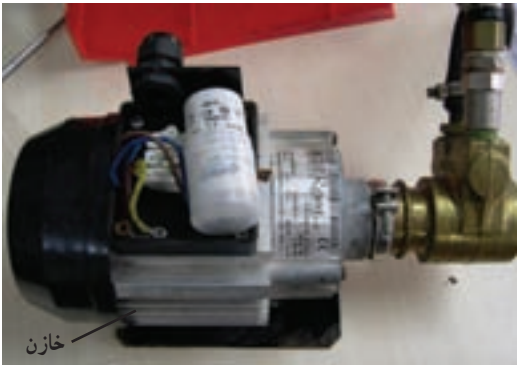
الف) وضعیت ظاهری الکتروپمپ آب
