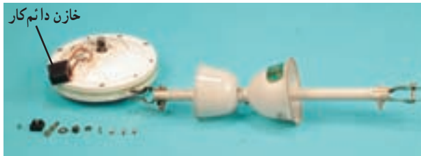
الف) موتور پنکه سقفی
