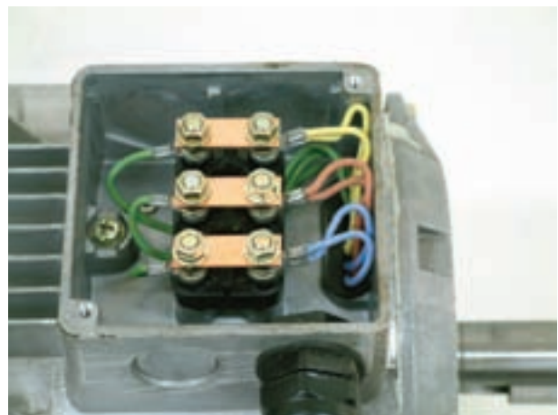
شکل ۱۴-۹- اتصال مثلث سیم پیچ های موتور
