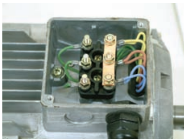
شکل ۹-۱۳ - اتصال ستاره سیم‌پیچ‌های موتور
