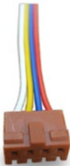
شکل ۳-۳: ترتیب رنگ سیم‌ها و وظیفه هر کدام در سوکت کوماکس
