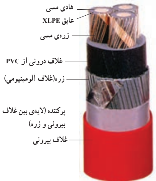
شکل ۴-۳۹- کابل با غلاف آلومینیومی
