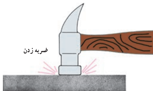
شکل ۱۴-۵- خنثی کردن اثر مغناطیسی آهن ربا با زدن ضربه
