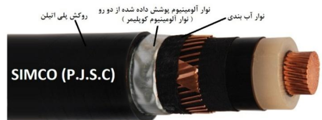
شکل 6: نمونه کابل تولید شده با آلومینیوم کویلیم و روکش پلی اتیلن به همراه نوار نیمه هادی آب بندی بین آلومینیوم کویلیم و اسکرین
