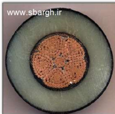
شکل ۱۱. هادی میلیکن دارای چند قطاع که بدون بکارگیری غلتک‌های افقی تولید شده است
