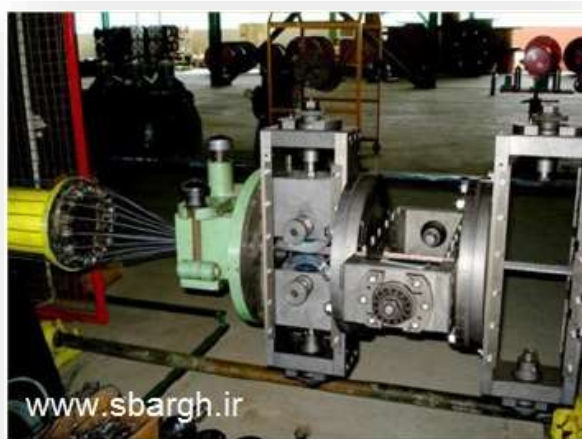
شکل ۱۳. در این ماشین، تنها غلتکها و محورهای چرخان آن جدید است.
