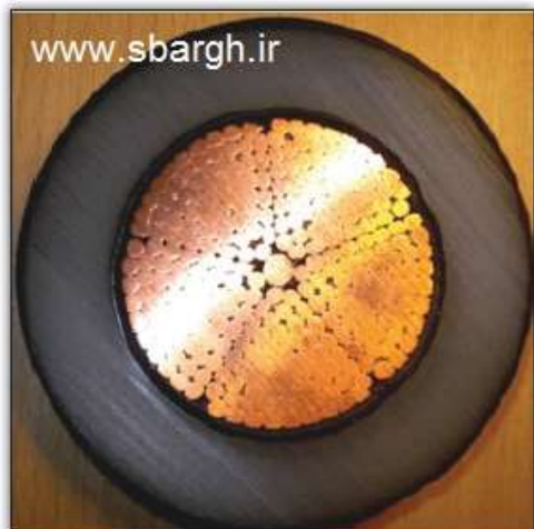
شکل ۱۰. هادی میلیکن دارای چند قطاع که با بکارگیری غلتک‌های افقی تولید شده است
