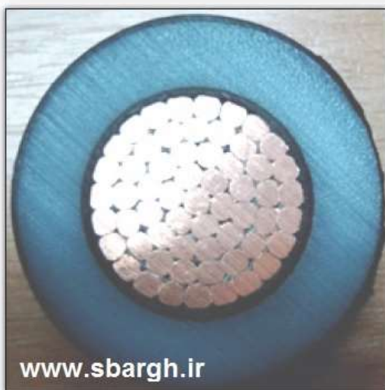
شکل ۳. این هادی با استفاده از قالبهای سخت فشرده شده است
