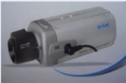
شکل ۳-۲۲ اتصال کابل لنز اتوایریز به دوربین
