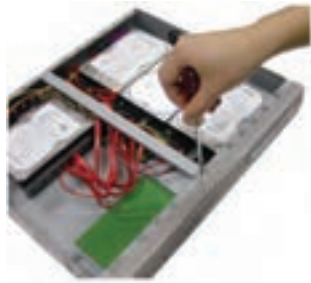
شکل ۳-۶۸ دیسک سخت نصب شده در داخل دستگاه
