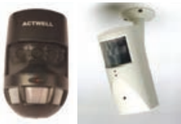
شکل ۱۴-۳ دوربین‌های تشخیص دهنده حرکت
