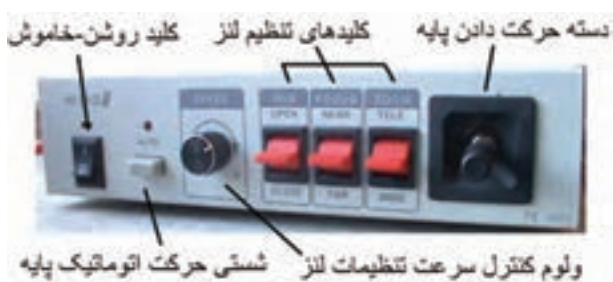
شکل ۳-۵۵ قسمت‌های مختلف جلو کنترل کننده
