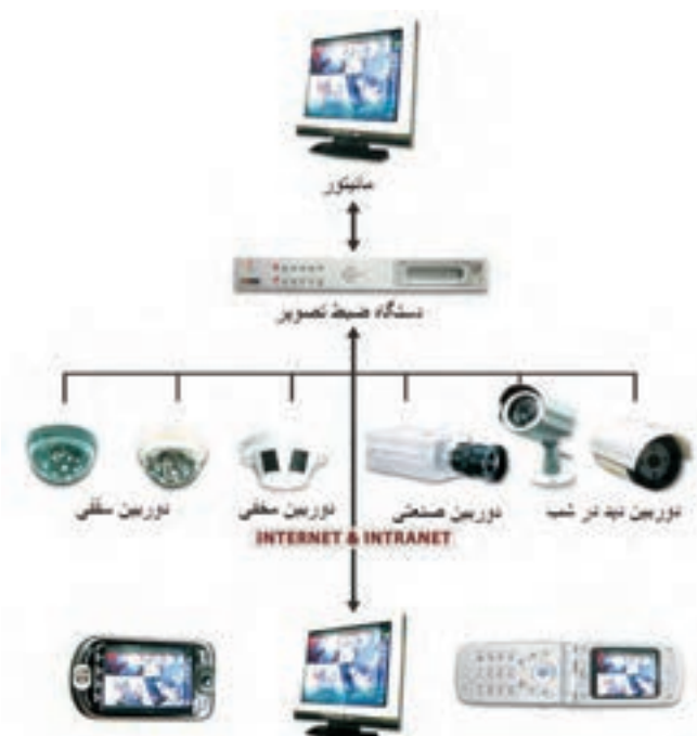
شکل ۳-۷۹ دیاگرام کلی اتصالات یک نمونه سیستم دوربین مدار بسته
