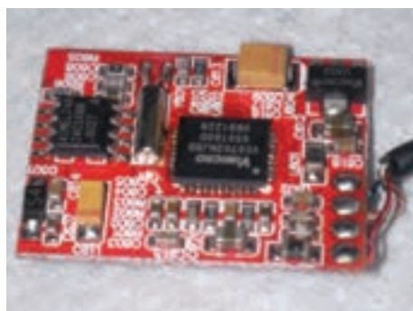
شکل ۳-۲۵ مدار الکترونیکی دوربین
