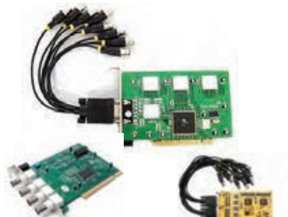
شکل ۳-۷۵ کارت‌های ضبط ۴ و ۸ و ۱۶ کانال
