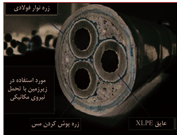
شکل ۸. زره کابل مورد استفاده در زیر زمین
