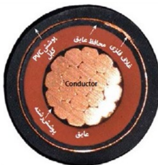
شکل ۶. پوشش الکترواستاتیکی روی عایق
