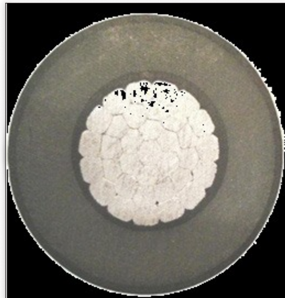
شکل ۲. این هادی با استفاده از غلتک ها فشرده شده است
