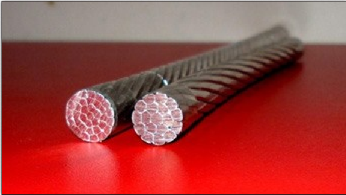
شکل ۴. دو هادی با سطح مقطع یکسان ولی با تعداد و ترتیب قرارگیری و قطر سیم متفاوت
