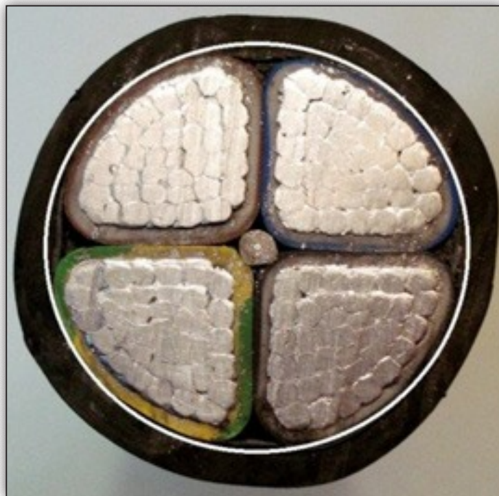
شکل ۸. فشردگی و گردی کابل بسیار خوب است
