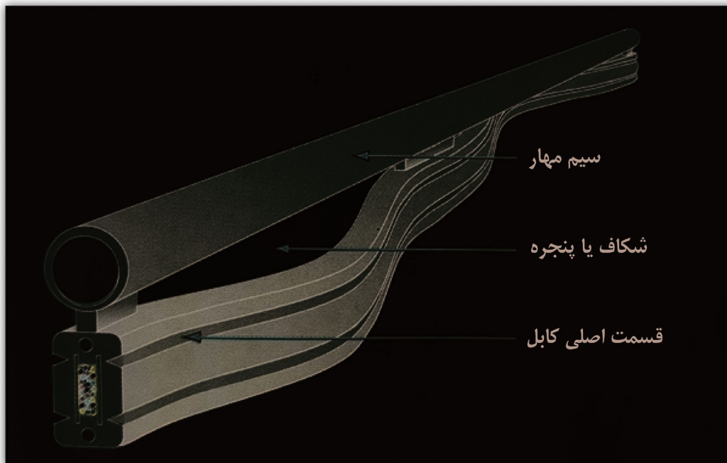
شکل ۶. ساختار کابل هوایی با شکاف یا پنجره
