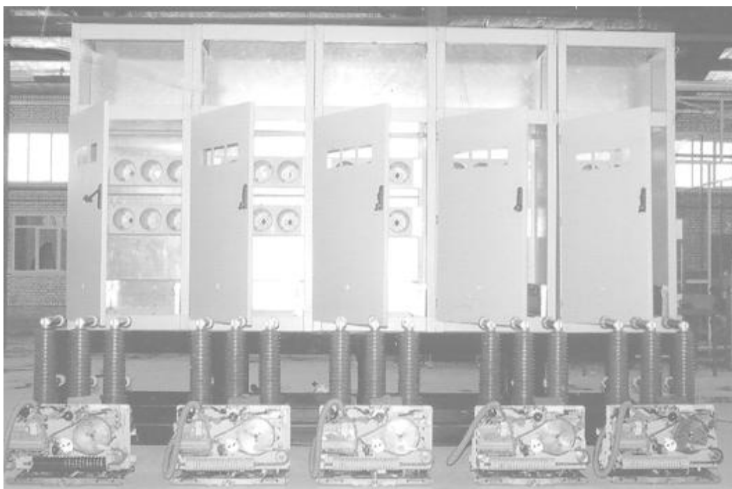
شکل (۲): بدنه تابلوی فلزی ۵ سلول یک پارچه
