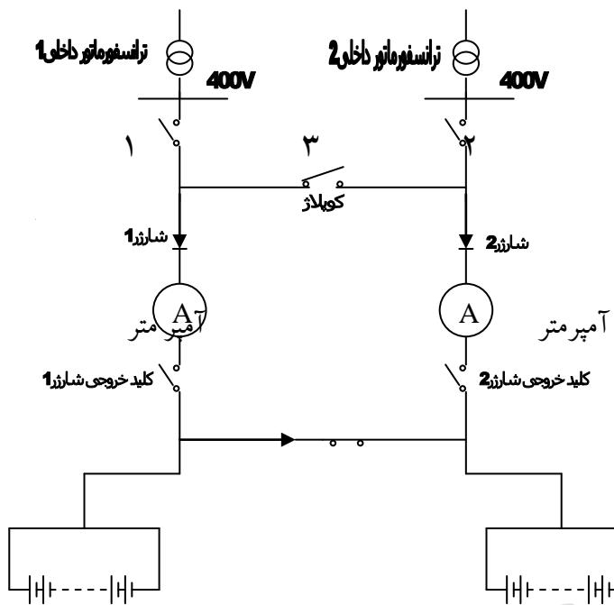
از کلیدهای ۱ و ۲ و ۳ فقط دو کلید در آن واحد می‌تواند بسته باشد
